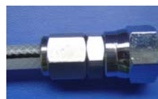
③ナット部を最後まで締めつける。
