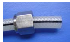
①ナット部をホースに5cm程度挿入！
